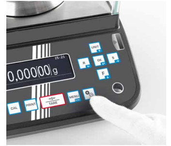
Ionisator (im Lieferumfang enthalten) durch Knopfdruck aktivierbar
