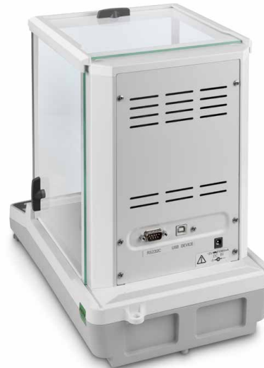
Datenschnittstellen RS-232 und USB zum Übertragen von Wägedaten an PC, Tablet oder Drucker
